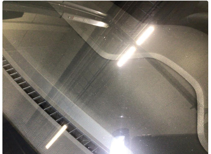
1.1 Noe steinsprut på frontvindu
