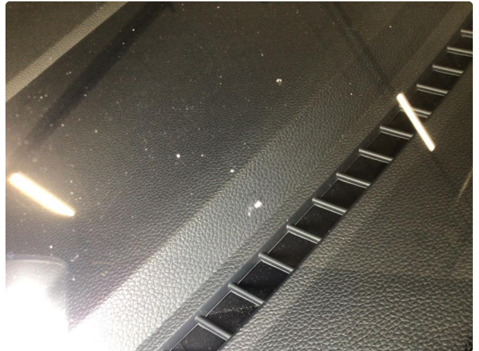
1.1 Noe steinsprut på frontvindu
