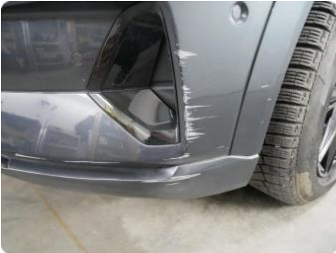
1.1 Riper på frontfanger venstre side utbedret hos Møller Bil Skadesenter 29.12.2025
