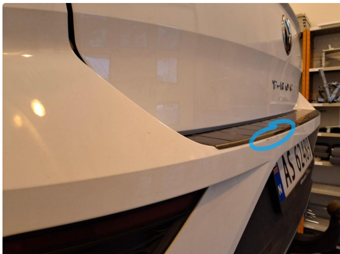
1.1 Ripe(r) ned til grunning
