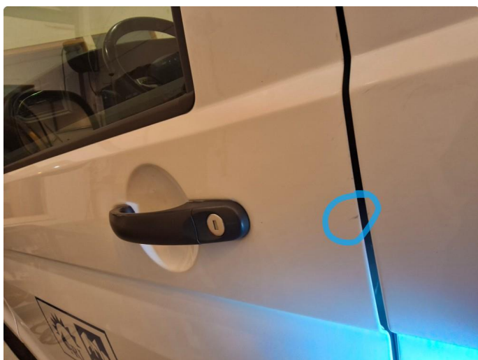
1.2 Ripe ned til grunning
