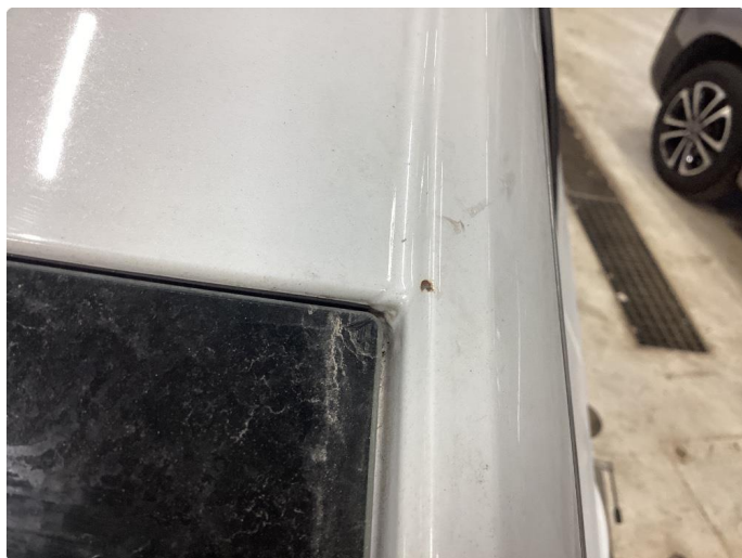
1.5 Steinsprut med rust
