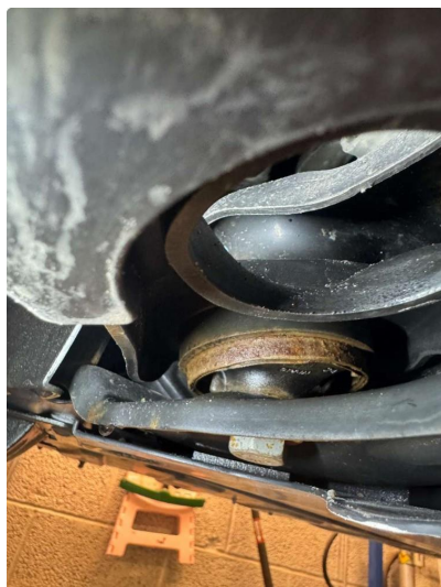
1.1 Slitt bærebruforing, blir byttet før levering
