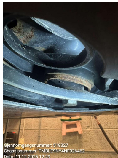
1.1 Slitt bærebruforing, blir byttet før levering
