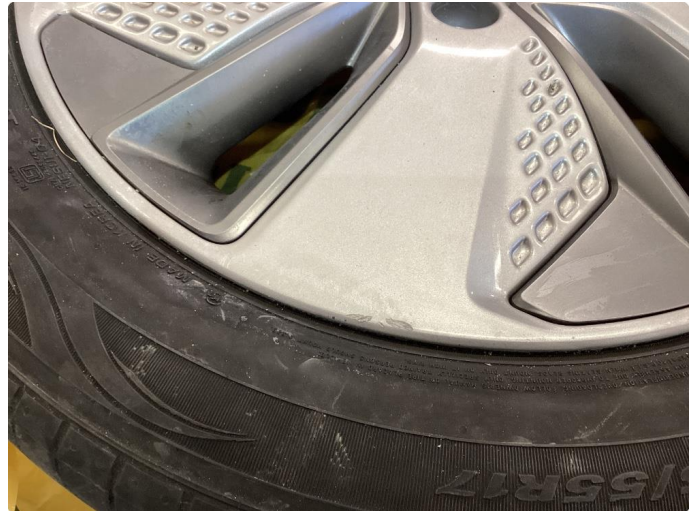
1.1 Skade på felg
