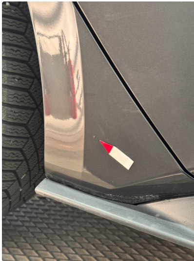
1.3 Liten steinsprut med korrosjon.
