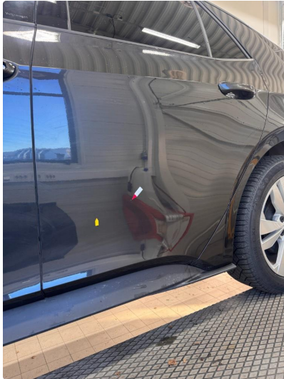
1.2 Liten steinsprut med korrosjon.
