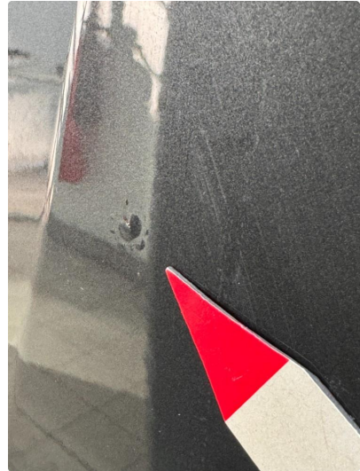
1.3 Liten steinsprut med korrosjon.
