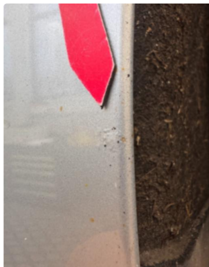
1.2 Liten steinsprut med korrosjon venstre bakskjerm.
