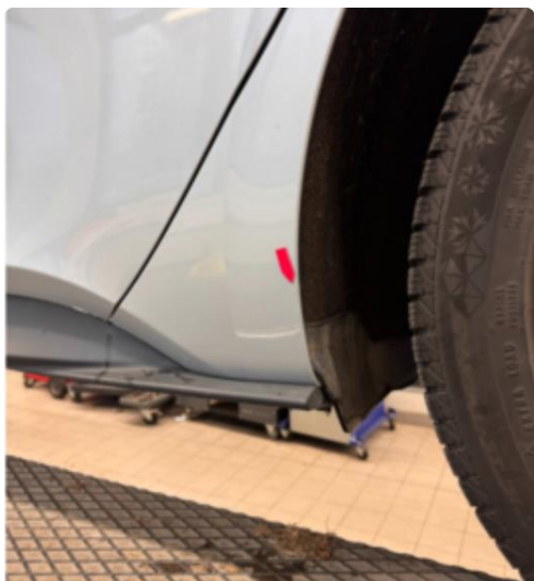
1.2 Liten steinsprut med korrosjon venstre bakskjerm.
