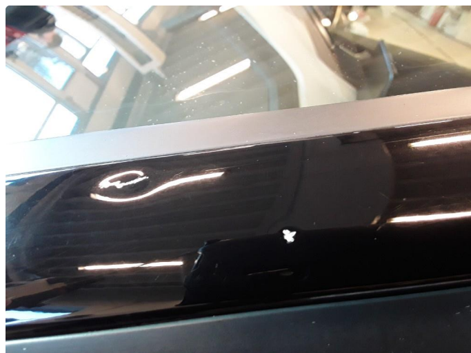
1.2 Liten bulk venstre a-stolpe. Blir forsøkt med bulkfix.
