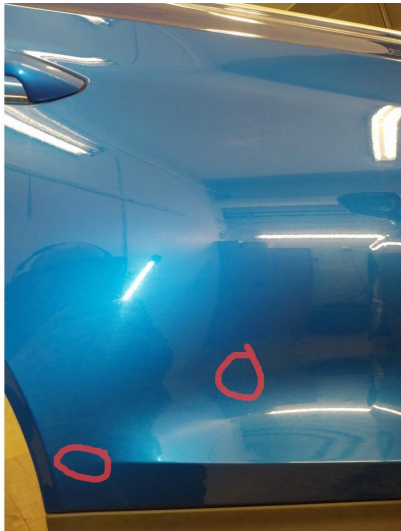
1.1 Steinsprut med rust
