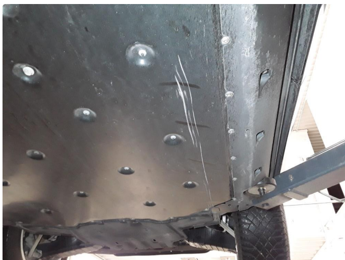
1.1 Noen små riper på beskyttelsesdeksel under bilen. Ingen deformasjoner. Normal bruksslitasje
