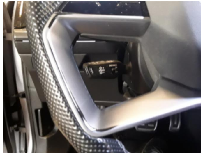
2.1 Noe slitasje på ratt.
