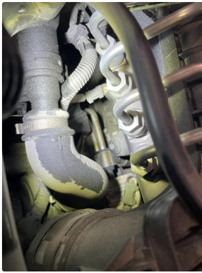
3.3 Oljelekkasje fra motor
