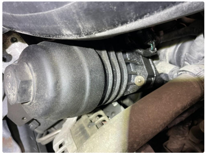
3.3 Oljelekkasje fra motor
