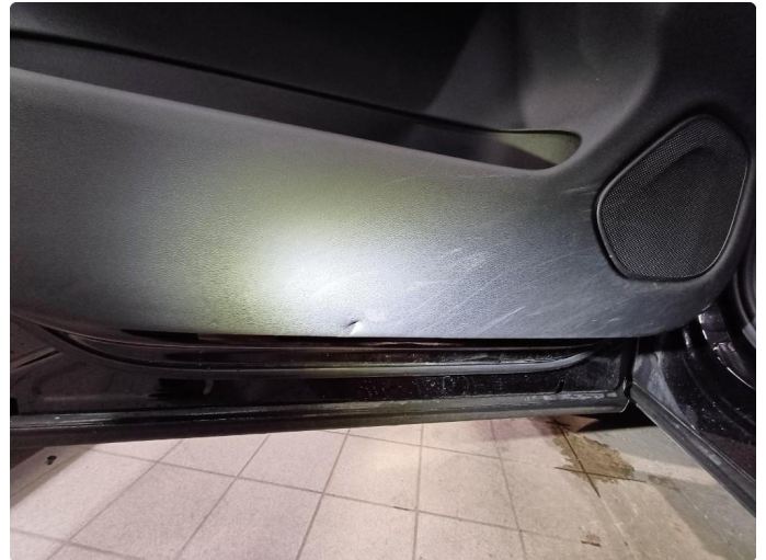
1.1 Slitasje innsiden av døren
