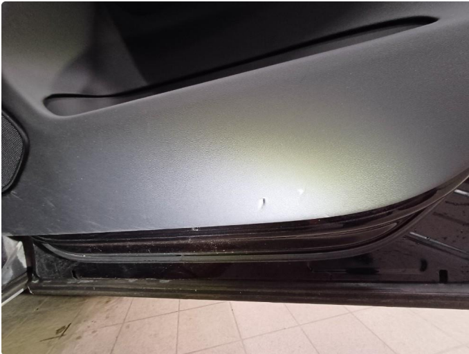
1.1 Slitasje innsiden av døren
