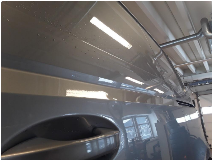
1.2 Liten bulk venstre skyvedør. Blir forsøkt med bulkfix.
