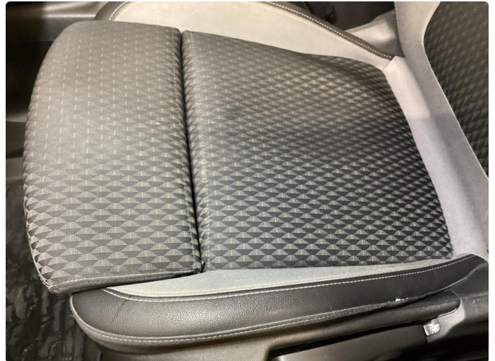
2.1 Skade på setetrekk
