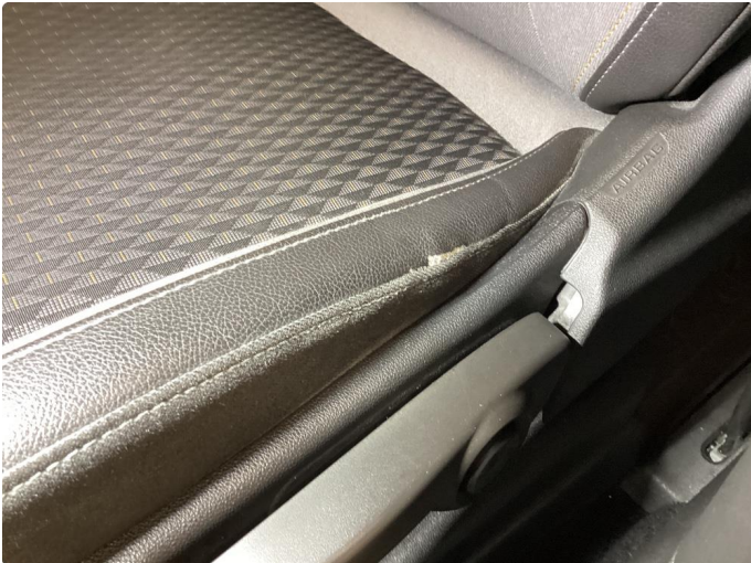
2.1 Skade på setetrekk
