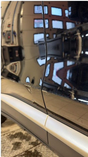
1.1 Parkeringsskade, bulk og stripe
