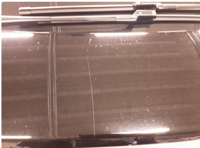
1.2 Noen riper på deksel over panser.
