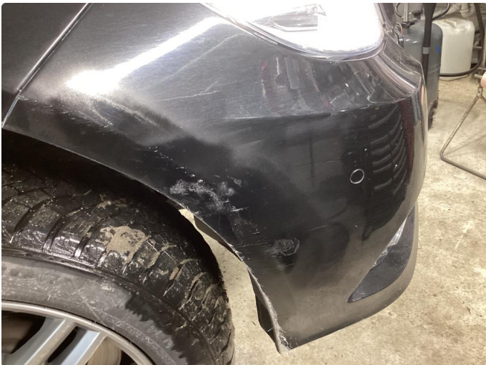
1.3 Ripe(r) ned til grunning
