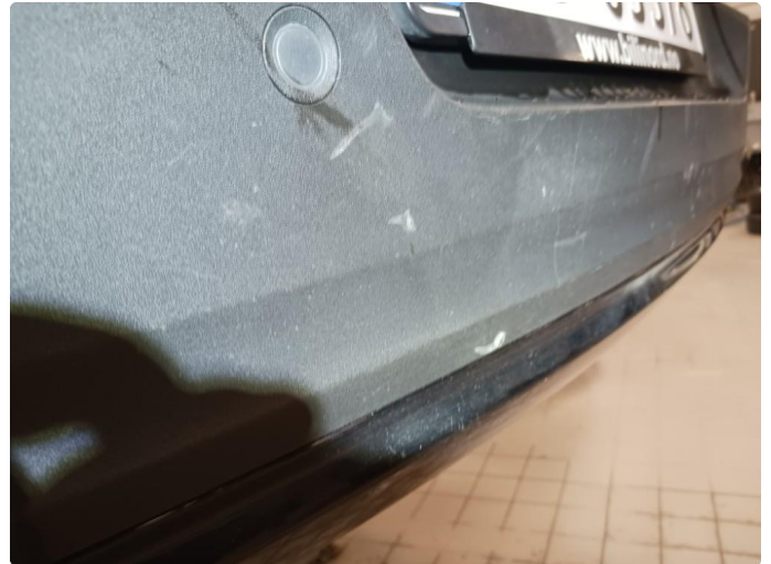
1.2 Merke i støtfanger bak
