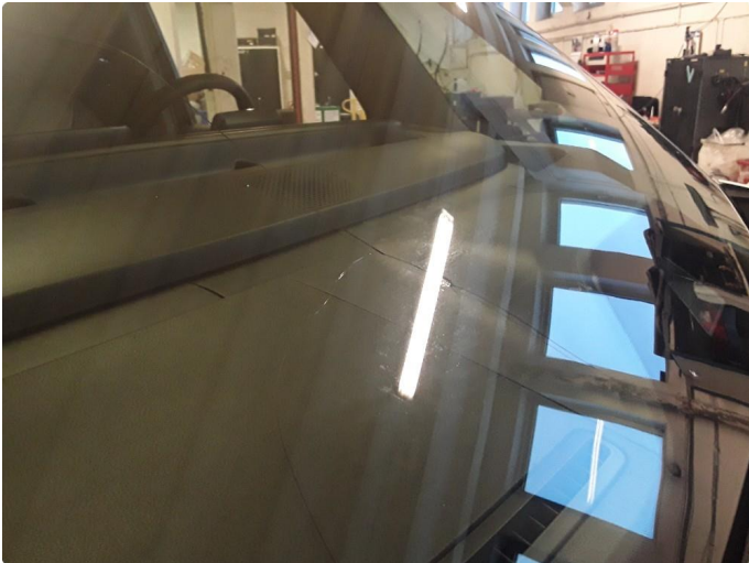
1.2 Steinsprut med sprekk
