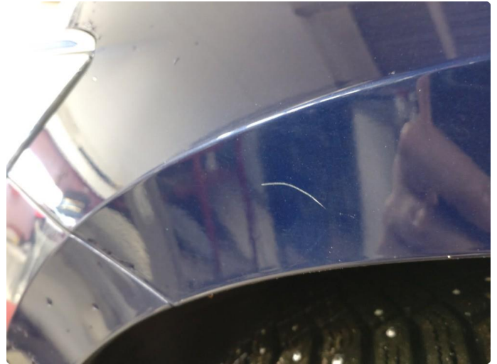
1.4 Ripe(r) ned til grunning
