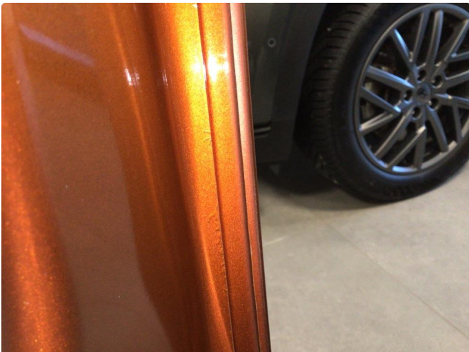
1.1 Noe korrosjon ved fals på venstre bakdør og begge framdører, dette er minimalt og av ubetydelig karakter
