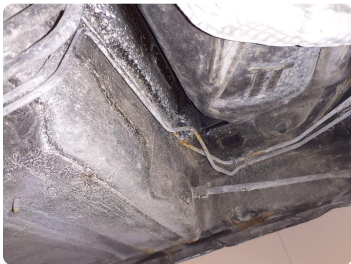
7.5 Rust Rust i bremseløp
