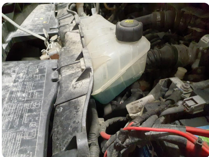
5.4 Kjøleveske under minimum Kjølevæske under minimum
