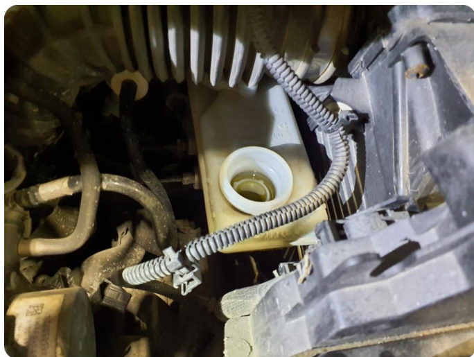
7.2 Øvrige feil Mangler lokk bremsevæske beholder
