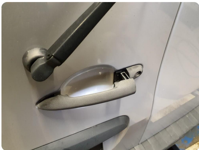
3.3 Håndtak virker ikke Bakluke stropet fast, må kontrolleres
