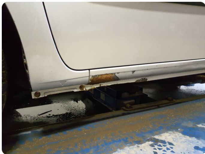
3.1 Generelt mye bruksslitasje Inkluderer flere riper og bulker og rust rundt om på bil
