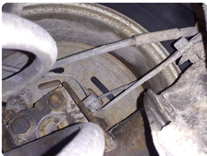
7.5 Rust Rust i bremseløp
