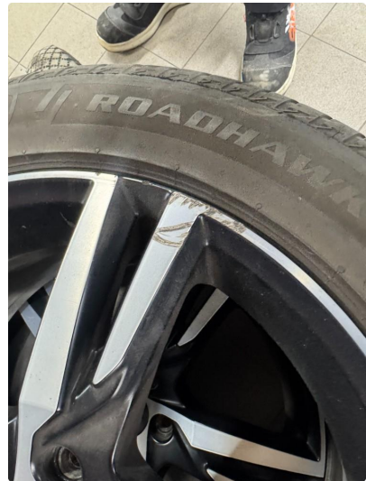
1.2 Skrubbskade på felg. Slitt ihht alder og km
