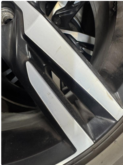
1.2 Skrubbskade på felg. Slitt ihht alder og km
