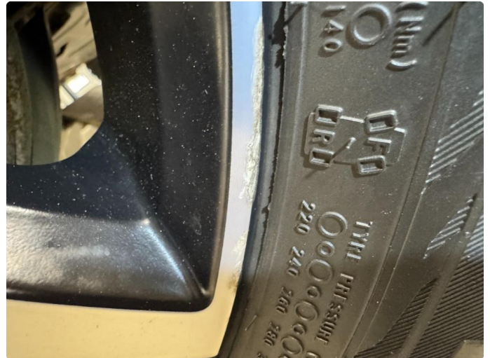
1.1 Skrubbskade på felg. Slitt ihht alder og km
