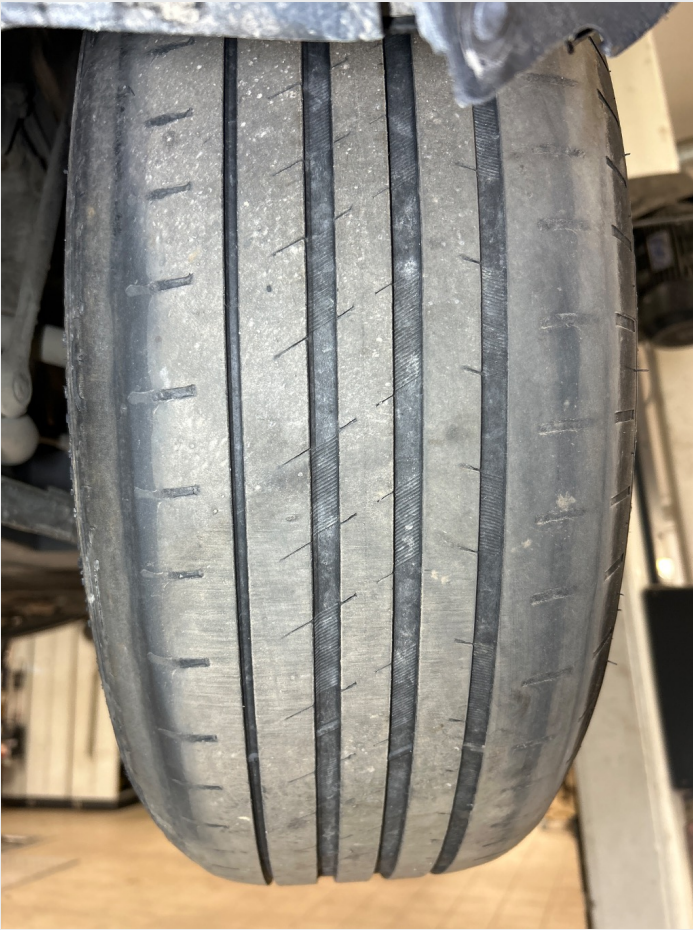
2.17 Dekk slitt innside og utside
