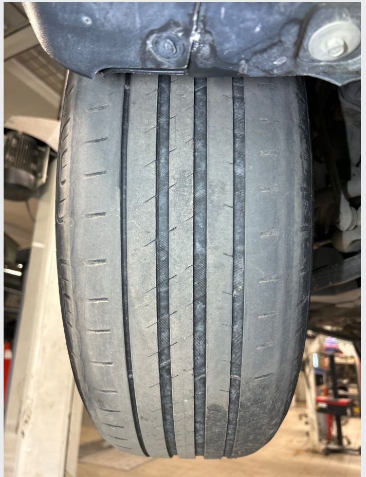
2.17 Dekk slitt inside og outside
