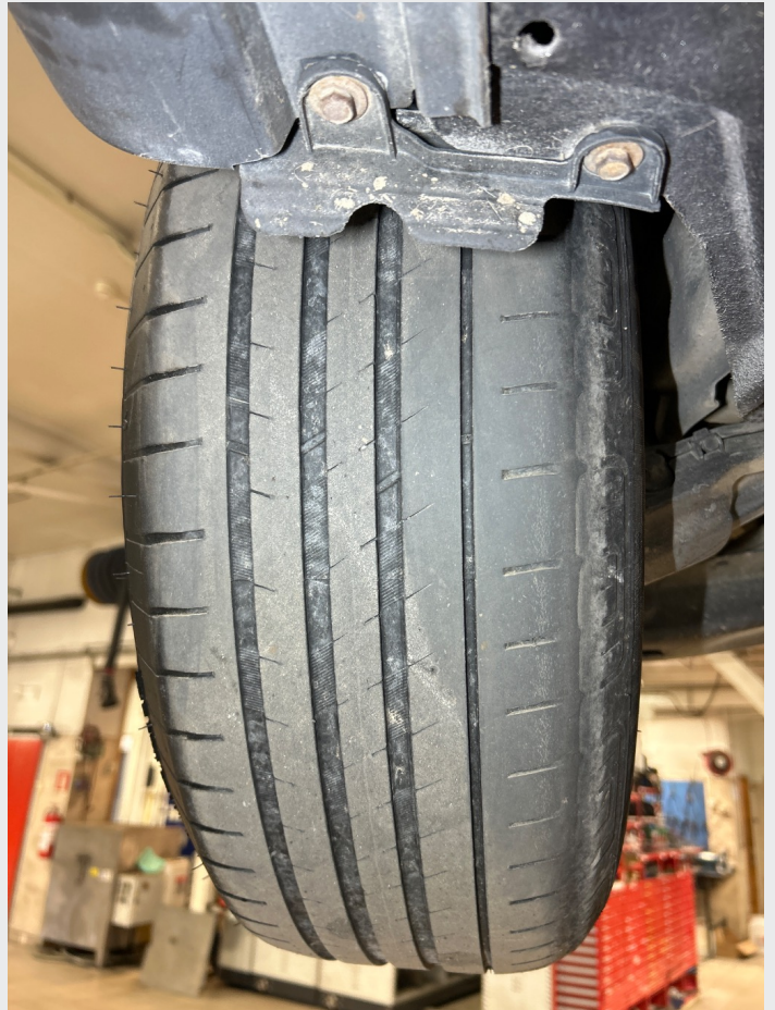
2.17 Dekk slitt inside og outside
