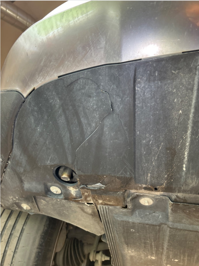
2.2 Fremste plate under bil er knust
