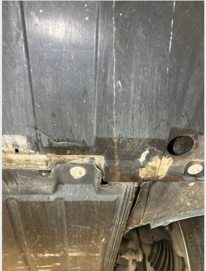
2.2 Fremste plate under bil er knust
