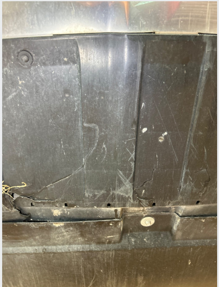
2.2 Fremste plate under bil er knust
