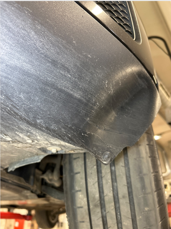
2.8 Bulk i nedre del av støtfanger foran
