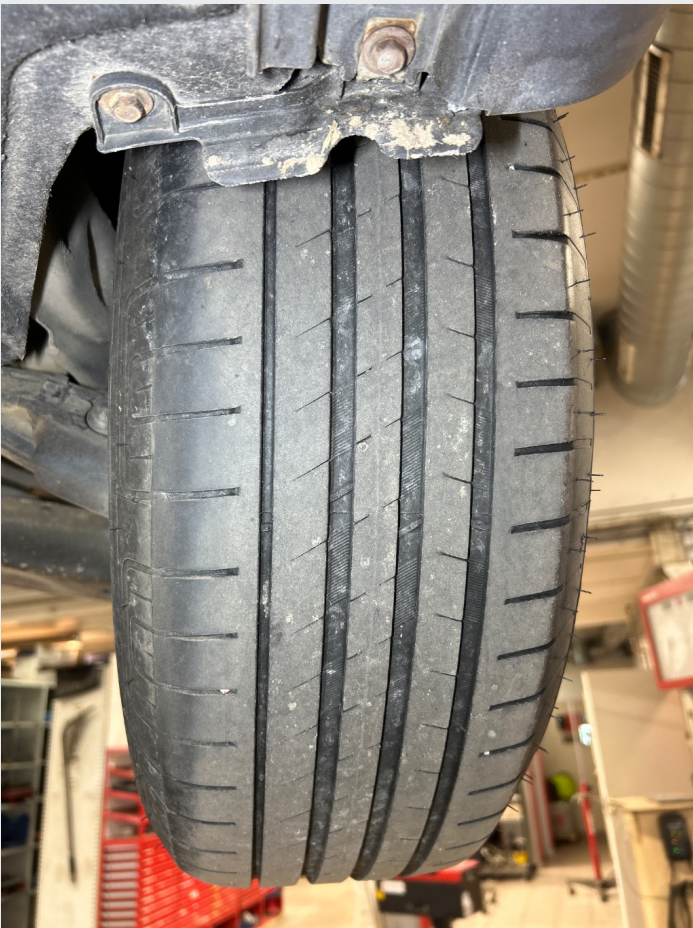
2.17 Dekk slitt inside og outside
