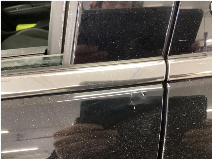
1.1 Noen bulker med lakkskader
