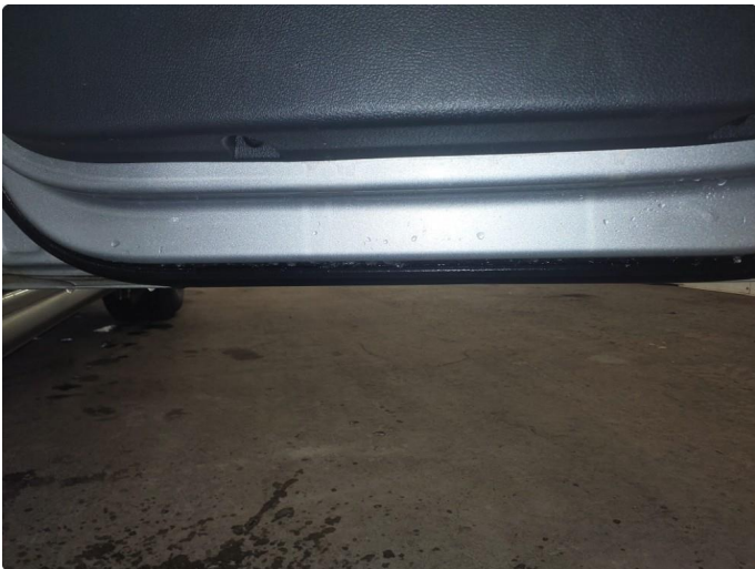
1.2 Oppsamling av vann, mulig tett drenshull.
