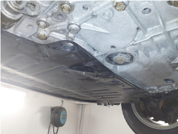
1.1 Beskyttelsesplate skade, mangler alle skruer bakkant/ rift
