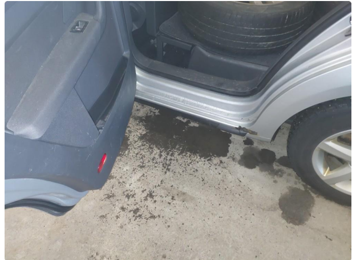
1.2 Oppsamling av vann, mulig tett drenshull.
