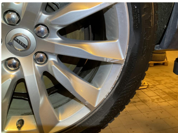
1.2 Merke på høyre felg bak
