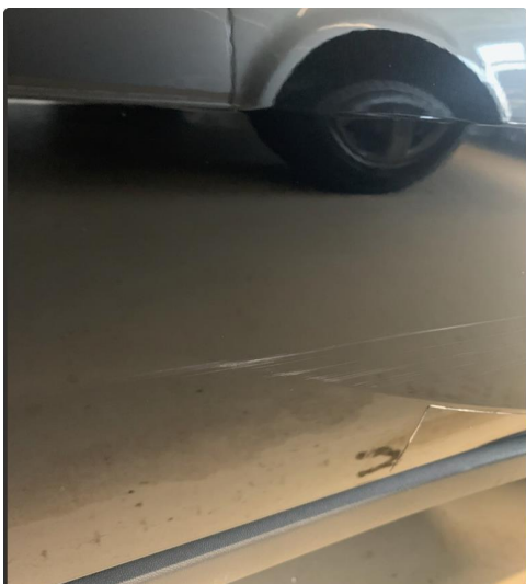
1.2 Noen riper og en liten steinsprut med korrosjon venstre bakdør.
