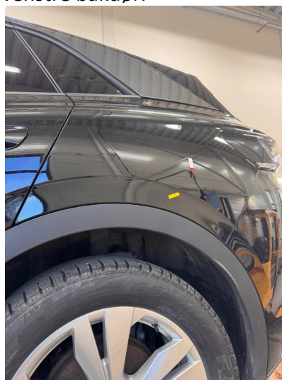
1.3 Liten steinsprut med korrosjon.
