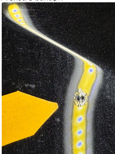
1.3 Liten steinsprut med korrosjon.
