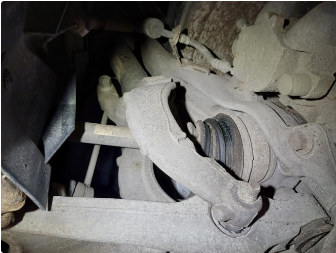
4.1 Drivakselmansjett defekt. Byttes
