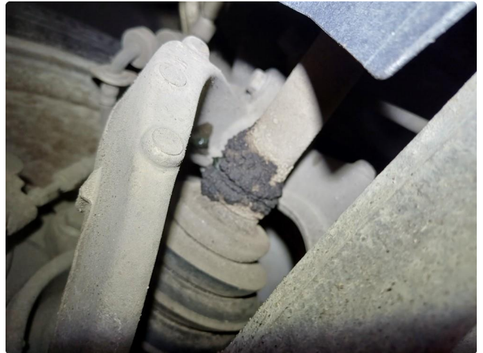
4.1 Drivakselmansjett defekt. Byttes
