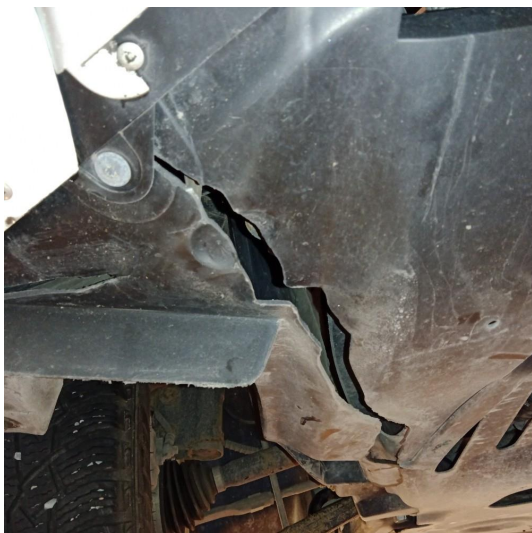
1.1 Beskyttelsesplate skadet/mangler. VURDERES VED SALG.
