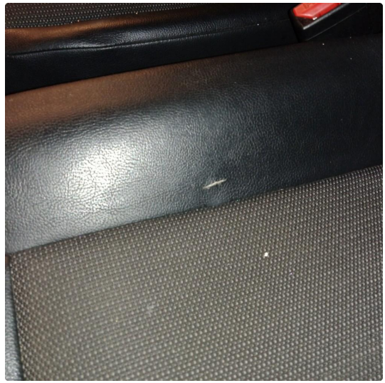
2.2 Skade på setetrekk. LITEN RIFT.
