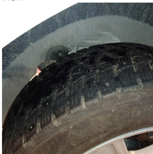
1.3 Piggdekk mangler pigger. VURDERES VED SALG.
