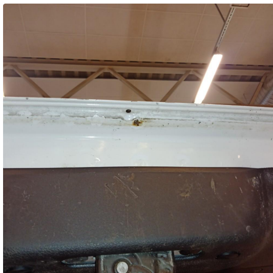
1.1 Rust/korrosjon. OVERFLATERUST, BØR GJØRES NOE MED I FREMTIDEN.
