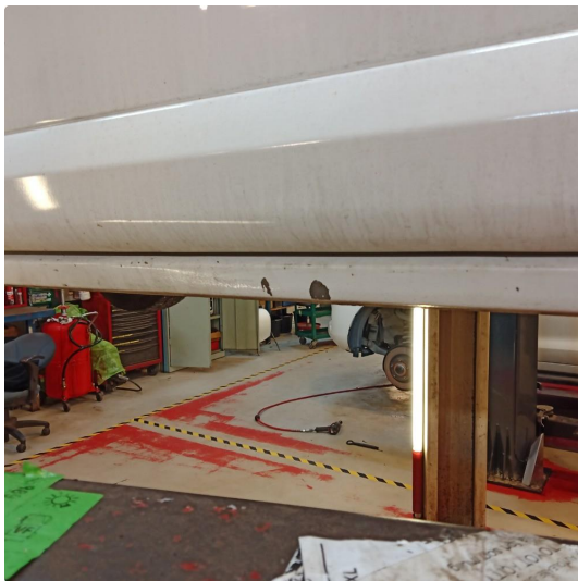
1.6 Ripe(r) ned til grunning. BØR GJØRES NOE MED I FREMTIDEN.
