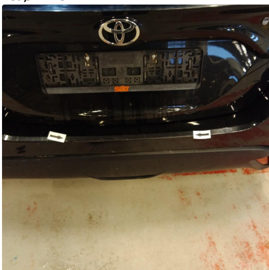
1.2 Ripe(r). UTBEDRINGER UTFØRT PÅ KLARGJØRINGEN.
