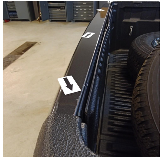
1.2 Diverse riper og små bulker på toppen av bakluke og deksel på bakluke er bøyd
