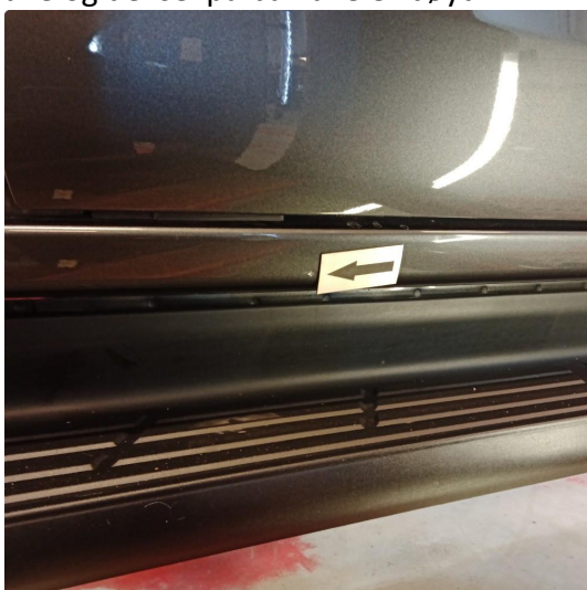
1.3 Liten bulk i kanal høyre side
