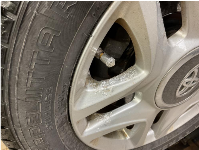
1.1 Påbegynnende oksidering på felger til vinter dekk
