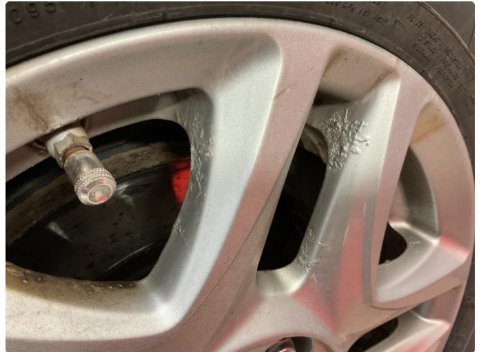
1.1 Påbegynnende oksidering på felger til vinter dekk
