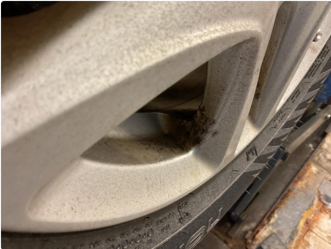
1.1 Påbegynnende oksidering på felger til vinter dekk
