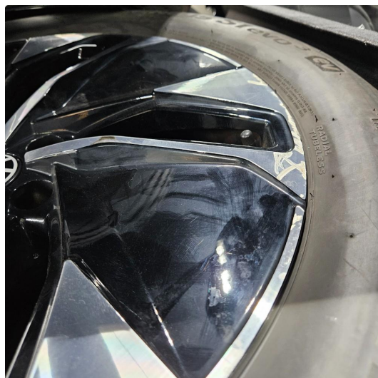
1.1 Skrubbermerker på en sommerfelg, foran
