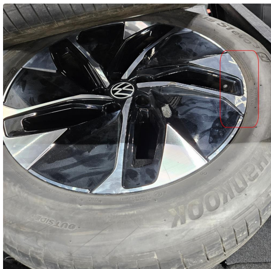
1.1 Skrubbermerker på en sommerfelg, foran
