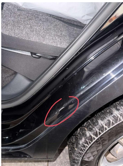
1.1 Noen riper og småbulker
