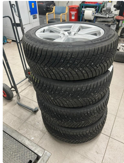
1.4 Piggdekk mangler pigger (nye hjul bestilt).
