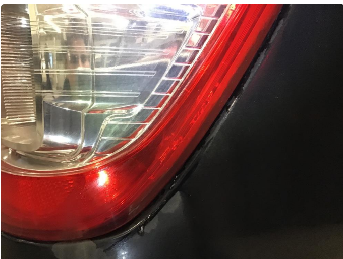
2.1 Antydning til krakelering i plast
