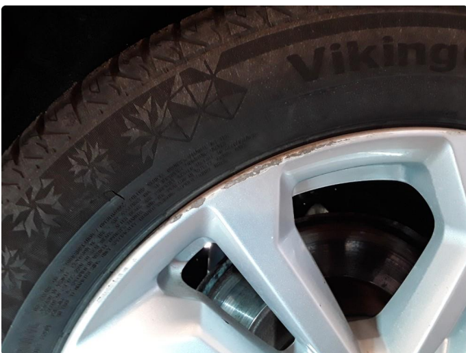
1.5 Noe kantkjørte vinterfelger.
