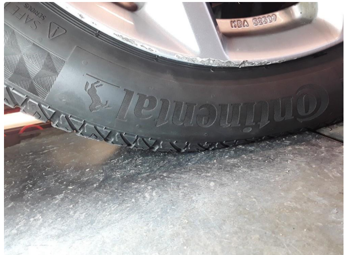
1.5 Noe kantkjørte vinterfelger.
