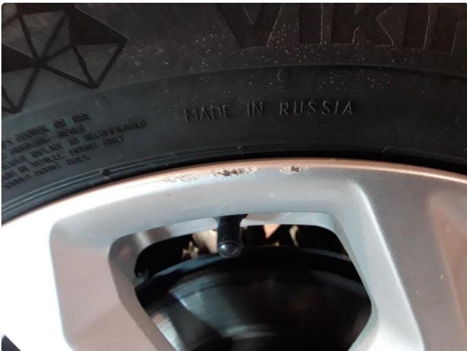
1.5 Noe kantkjørte vinterfelger.
