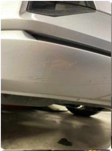
1.3 Ripe støtfanger foran høyre side utbedret hos Møller Bil Skadesenter 28.11.2025
