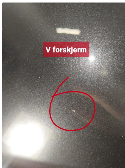
1.3 Steinsprut med rust
