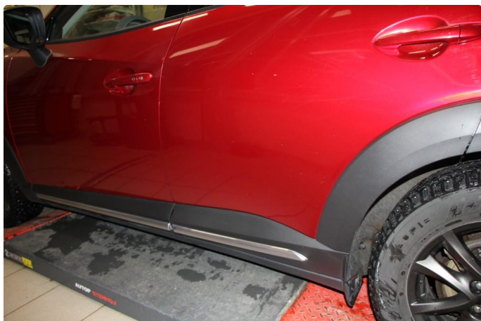
1.1 En del steinsprut langs hele venstre side av bil.
