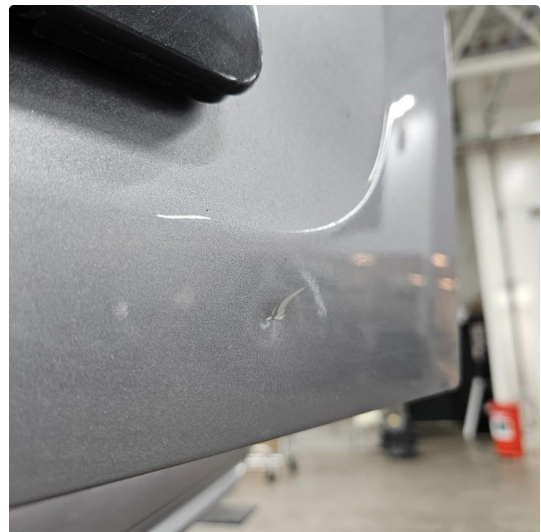
1.2 Bulk med lakkskade, v.bakdør
