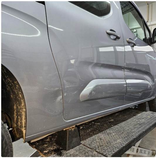
1.3 Bulker/lakkskader på skjerm og skyvedør, h.side
