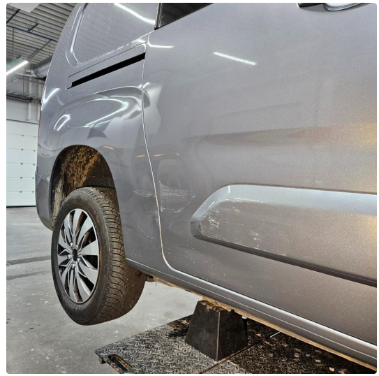
1.3 Bulker/lakkskader på skjerm og skyvedør, h.side
