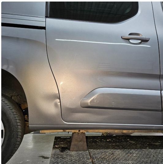
1.3 Bulker/lakkskader på skjerm og skyvedør, h.side
