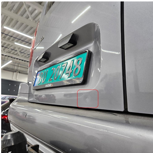
1.2 Bulk med lakkskade, v.bakdør
