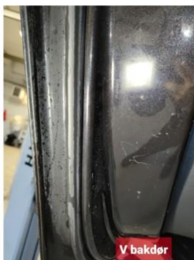
1.2 Noen dører har steinsprut med rust
