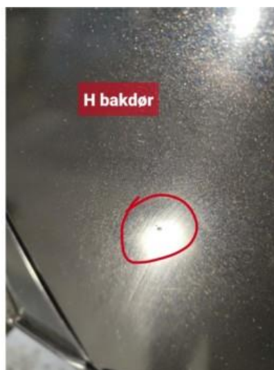
1.2 Noen dører har steinsprut med rust
