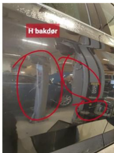
1.2 Noen dører har steinsprut med rust
