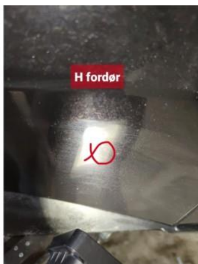
1.2 Noen dører har steinsprut med rust
