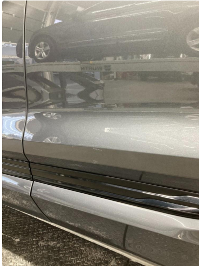
1.1 Liten ripe på venstre bakdør. Har blitt penslet med lakk
