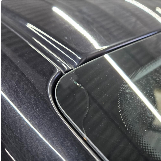
1.3 Steinsprut med sprekk utenfor synsfelt, oppe på h.side
