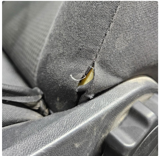
4.1 Løsnet søm på setetrekk, v.side
