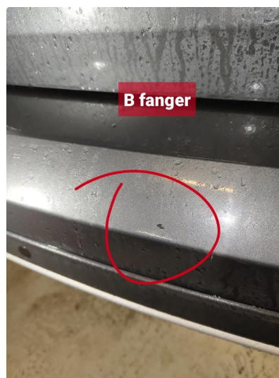
1.3 Ripe(r) ned til grunning
